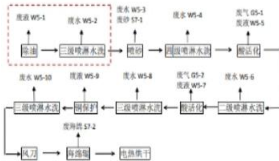
图 3.2-8 喷砂线工艺流程图（HSD）
